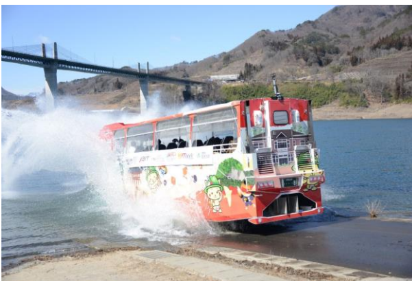
水陸両用船の自動運航による入水シーン（日本財団提供）
